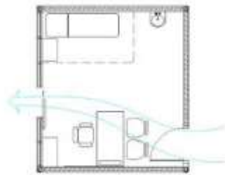
Gambar Contoh: Aliran udara yang tidak diharapkan dikaitkan dengan tata letak furnitur dalam ruangan
