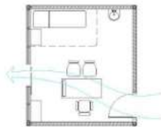
Gambar Contoh: Aliran udara yang diharapkan dikaitkan dengan tata letak furnitur dalam ruangan
